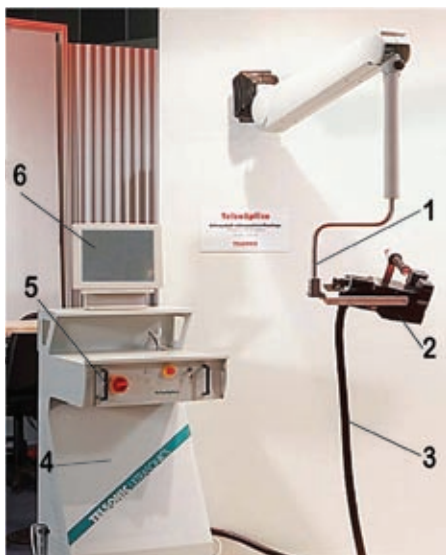
Рис. 1. Оборудование TelsoSplice для ультразвуковой сварки многожильных медных проводов: рабочее место сварщика. 1 — кронштейн с компенсатором веса; 2 — узел сварки; 3 — электро- и пневмомагистраль; 4 — консоль с генератором 3 кВт; 5 — контроллер; 6 — информационный дисплей
