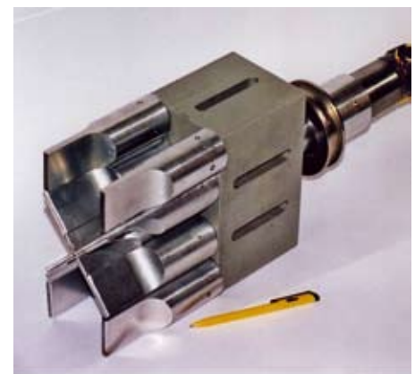
Рис. 3. Комбинированный инструмент — волновод (сонотрод) для прессовой сварки полимеров
