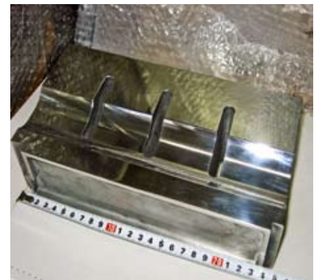
Рис. 2. Инструмент — волновод (сонотрод) для прессовой сварки полимеров
