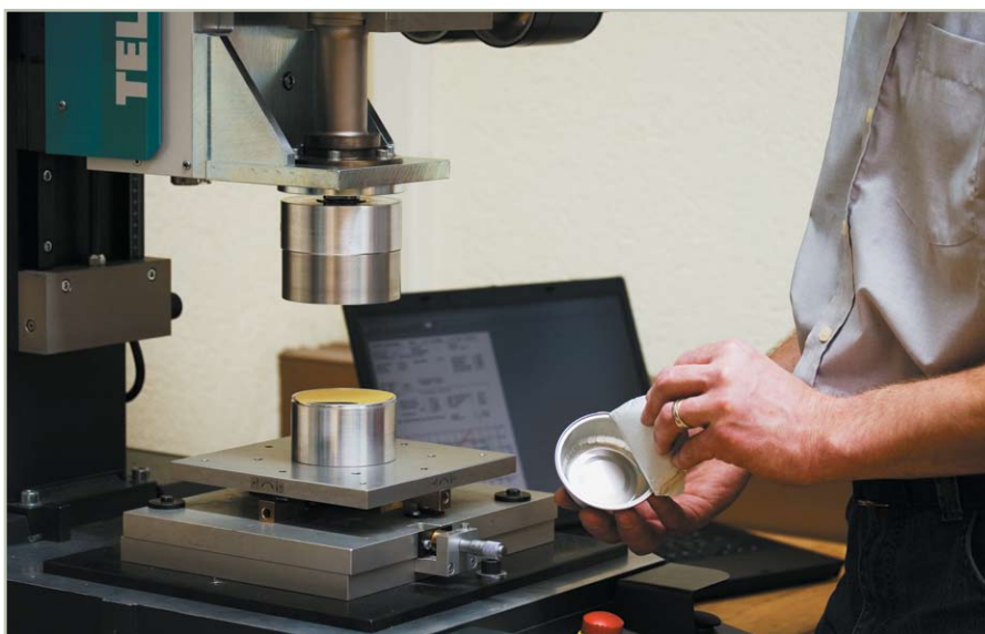
■ Оборудование для сварки ламинированной упаковки реализующее технологию «SONICTWIST». Оборудование фирмы «Telsonic Ultrasonic»
