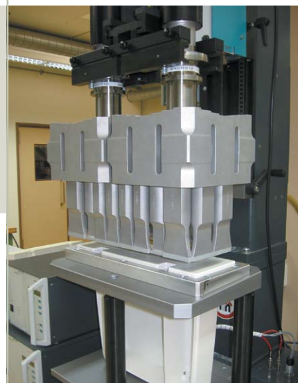
■ Пример комбинированной УЗС системы для сварки габаритной детали. Оборудование фирмы «Telsonic Ultrasonic»
