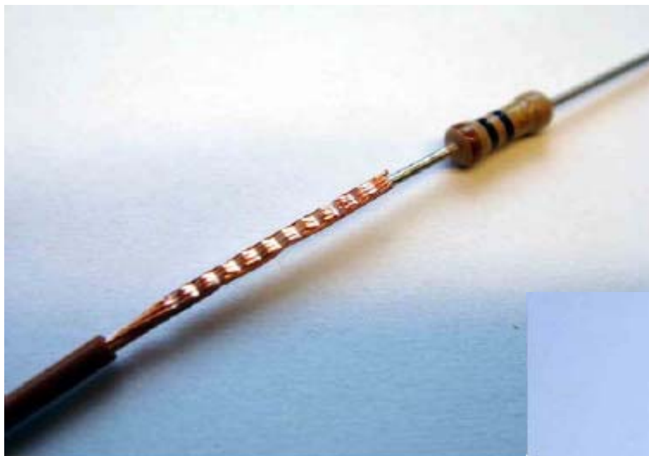
Медный гибкий многожильный проводник сварен с контактом резистора
